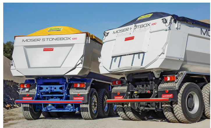
Links ein hydraulisch hochschwenkbarer Rückladen RLHH, rechts ein RLHH 2+ mit Doppelschiebersystem.
